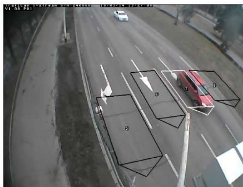
Obr. 13 Zobrazení pozemní komunikace pomocí dopravního detektoru
